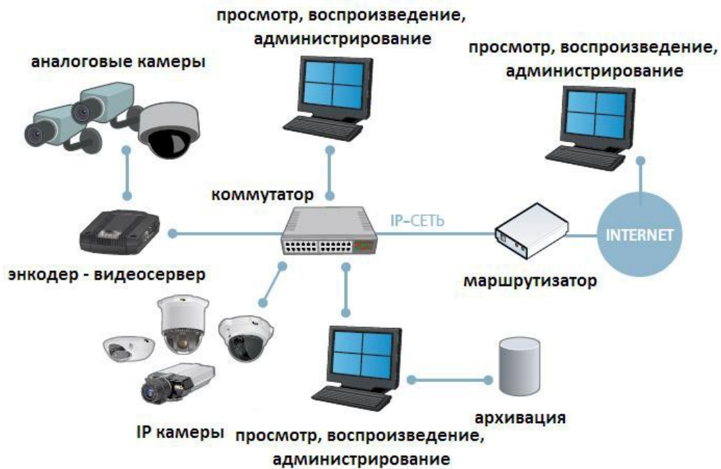
Рисунок 6 – Гибридная система видеонаблюдения из аналоговых и IP-камер
