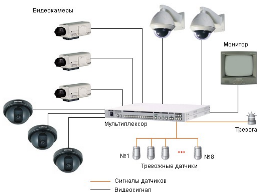
Рисунок 1 – Аналоговая система видеонаблюдения на основе мультиплексора
