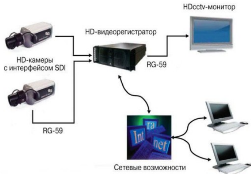
Рисунок 7 – Схема телевидеосистемы высокой четкости
