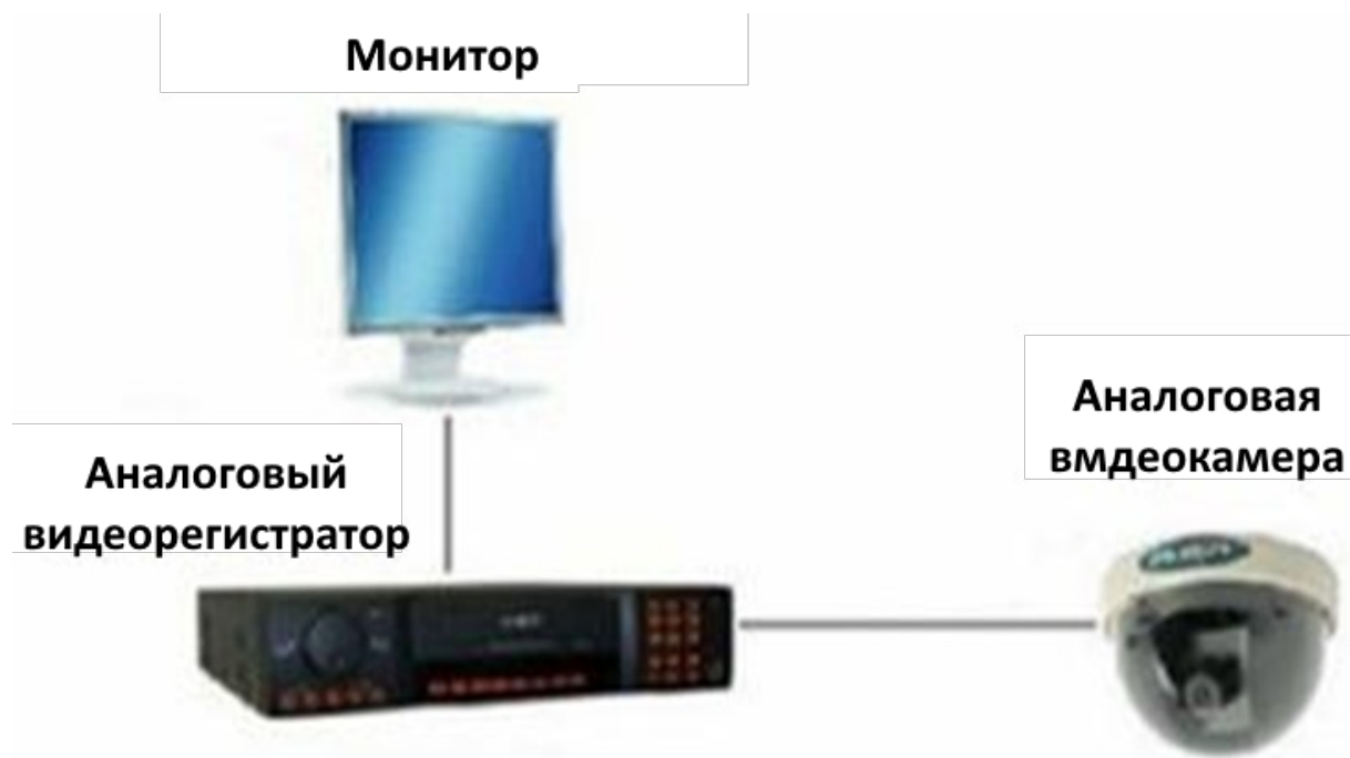
Рисунок 2 – Аналоговая система видеонаблюдения на основе видеорегиcтpатора
