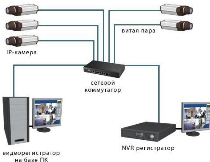
Рисунок 3 – Локальная цифровая система видеонаблюдения
