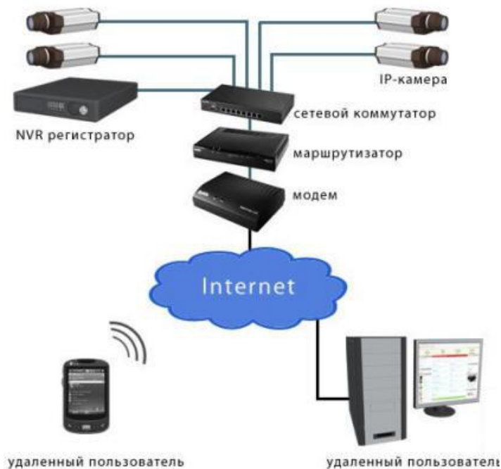
Рисунок 4 – Цифровая система видеонаблюдения с выходом в интернет
